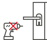
Non forare mai il dispositivo quando la serratura è stata installata.
